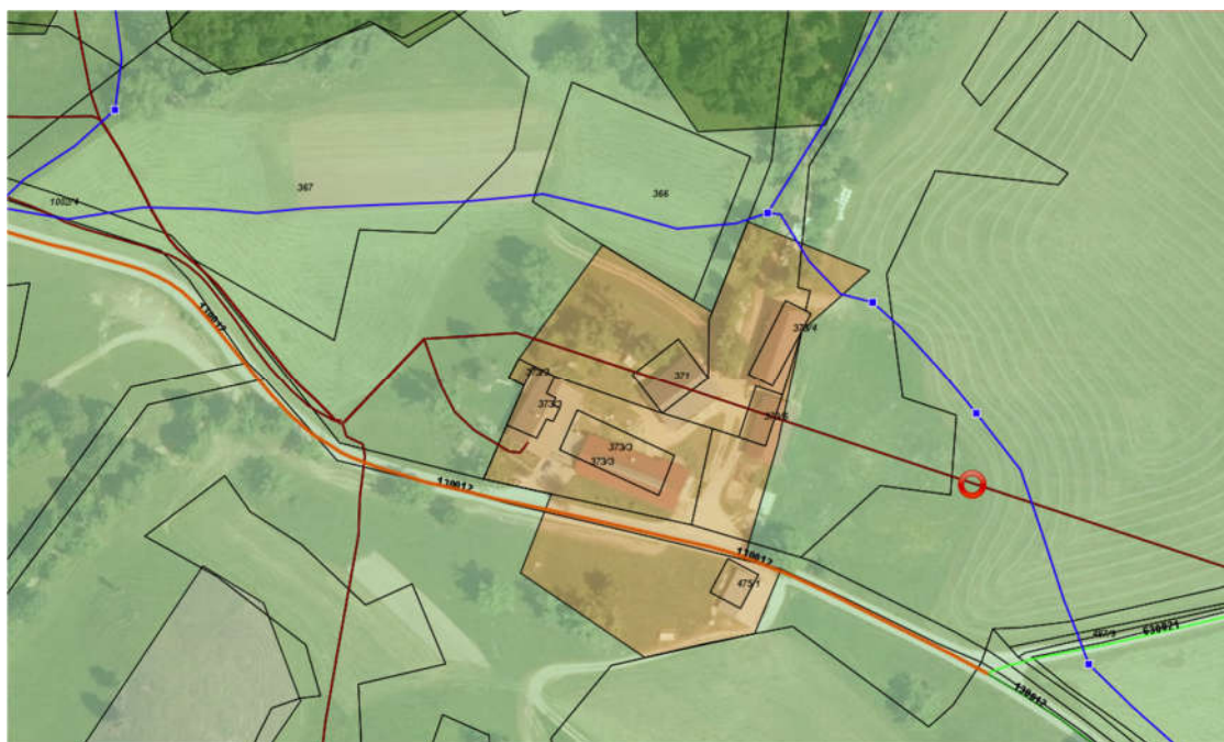
Slika 4:: Javna infrastruktura (modro - vodovod, rjava - elektrika)
